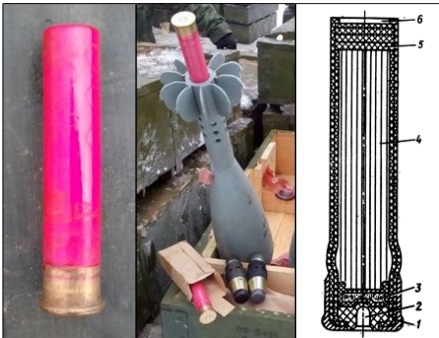
Рисунок 7 Загальний вигляд і будова основного заряду 010/54-Ж-843.
